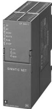
procesador de comunicaciones CP 343-1 para conectar SIMATIC S7-300 a Industrial Ethernet vía ISO y TCP/IP, PROFINET IO Controller o PROFINET IO Device, 2-Port Switch integrado ERTEC 200, comunicación S7, fetch/write, SEND/RECEIVE RFC1006, Multicast, DHCP, NTC- CPU Sync, con y sin diagnóstico, inicialización vía LAN, 2 conexiones RJ45 para LAN con 10/100 Mbits/s
