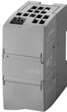
Compact Switch Module CSM 1277 para conectar SIMATIC S7-1200 y hasta 3 dispositivos más a Industrial Ethernet con 10/100 Mbits/s; unmanaged switch, 4 puertos RJ45, alimentación externa 24 V DC diagnóstico LED, módulo S7-1200 incl. manual de producto electrónico en CD-ROM
