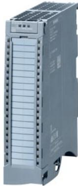
SIMATIC S7-1500, módulo de entradas analógicas AI 8xU/I HF, resolución de hasta 24 bits, precisión 0,1 %, 8 canales en grupos de 1, tensión en modo común: 30 V AC/60 V DC, diagnóstico; alarmas de proceso valores medidos escalables, adaptación del rango de medida, calibración en RUN. El suministro incluye elemento de alimentación, abrazadera de pantalla y clip de pantalla: conector frontal (bornes de tornillo o de inserción rápida) pedir por separado
