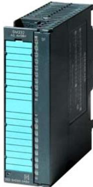
SIMATIC S7-300, Salida analógica SM 332, aislado galvánicamente, 8 AO, U/I; diagnóstico; resolución de 11/12 bits, 40 polos, desenchufar y enchufar con bus de fondo activo posible
