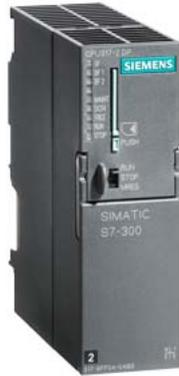
SIMATIC S7-300, CPU 317-2 DP, Módulo central con memoria de trabajo de 1 MB, 1.<sup>a</sup> interfaz MPI/DP 12 Mbits/s, 2.<sup>a</sup> interfaz maestro/esclavo DP, Se necesita Micro Memory Card
