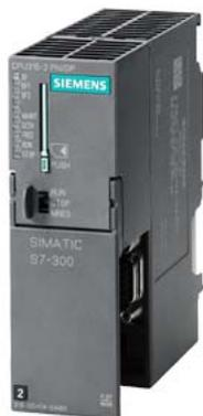
SIMATIC S7-300 CPU 315-2 PN/DP, Módulo central con memoria de trabajo de 384 kbytes, 1.ª interfaz MPI/DP 12 Mbits/s, 2.ª interfaz Ethernet PROFINET, con switch de 2 puertos, Se necesita Micro Memory Card
