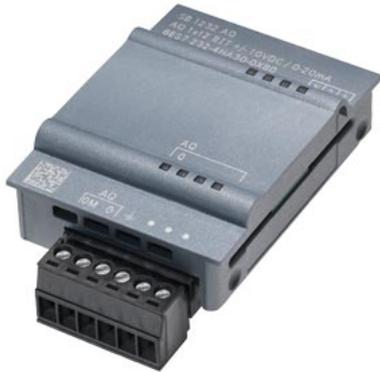
SIMATIC S7-1200, Salida analógica, SB 1232, 1 AO, +/-10V DC (resolución 12 bits) o 0-20 mA (resolución 11 bits)
