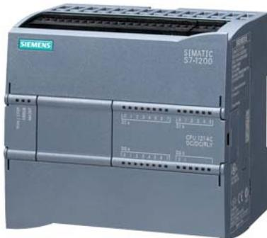
SIMATIC S7-1200, CPU 1214C, CPU compacta, DC/DC/relé, E/S integradas: 14 DI 24 V DC; 10 DO, relé 2 A; 2 AI 0-10 V DC, alimentación: DC 20,4-28,8 V DC, memoria de programas/datos 100 kB
