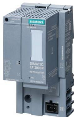
SIMATIC ET 200SP, bus de campo múltiple, módulo de interfaz 2 puertos, IM 155-6MF High Feature, PN IO, Ethernet IP, Modbus TCP, 1 slot para BusAdapter, máx. 64 módulos de periferia y 16 módulos ET 200AL, Multi Hot Swapping, alivio de tracción opcional, módulo servidor incluido
