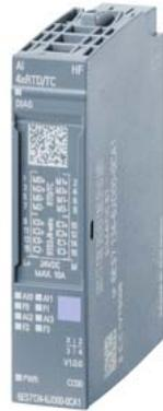
SIMATIC ET 200SP, módulo de entrada analógica, AI 4xRTD/TC High Feature, adecuado para tipo de BU A0, A1, código de color CC00, diagnóstico de canal, 16 bits, +/-0,1 %, 2/3/4 hilos
