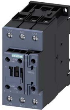
contactor, AC-3, 30 kW / 400 V, 1 NA + 1 NC, AC 110 V, 50 / 60 Hz, 3 polos, Tamaño S2, borne de tornillo
