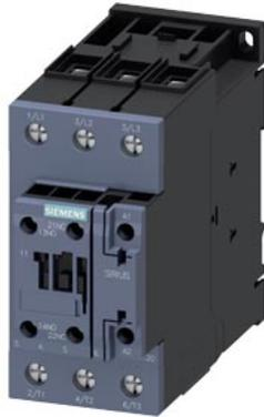
contactor de potencia, AC-3 51 A, 22 kW/400 V 1 NA + 1 NC, AC/DC 20-33 V, con varistor, tripolar, tamaño S2, borne de tornillo
