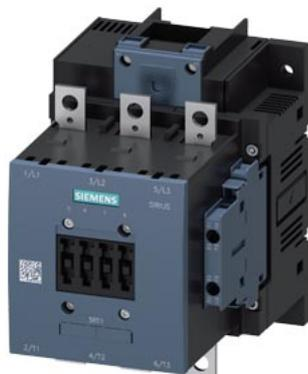
contactor de potencia, AC-3 185 A, 90 kW/400 V AC (50-60 Hz)/mando por corriente continua 220-240 V AC/DC contactos auxiliares 2 NA + 2 NC tripolar, tamaño S6 conexiones de barras accionamiento: convencional borne de tornillo
