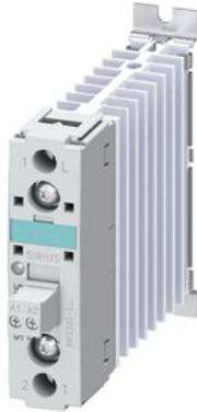
Contactor estático monofásico 3RF2 AC 51 / 20 A / 40 °C 48-600 V / DC 4-30 V borne de tornillo Tensión de bloqueo 1200 V
