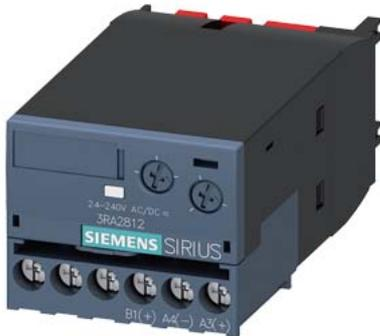
Relé temporizador electrónico retardado a desexcitación con señal de control y salida estática 24...240 V AC/DC rango de tiempo 0,05...100 s para fijar por presión en lado frontal para contactores 3RT2 S00/S0 y contactores auxiliares 3RH2 S00 bornes de tornillo Varistor para amortiguar las bobina de contactor integrado
