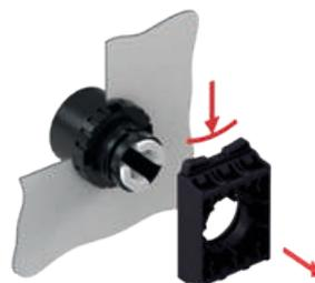
Presionar la lengüeta para remover la brida del frontal.
