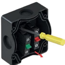
Posicione el destornillador en las extremidades del bloque para desconectarlo de la brida.
