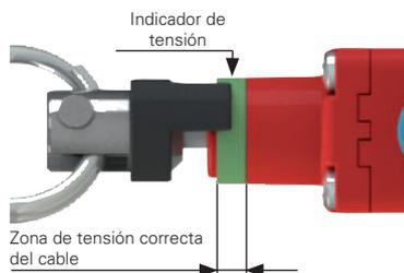
Todos los interruptores disponen de un anillo verde que indica la zona de tensión correcta del cable. El instalador solo tiene que tensar el cable hasta que el indicador de tensión negro llegue a la mitad del anillo verde. En este punto, se puede rearmar el interruptor tirando del botón azul para cerrar los
