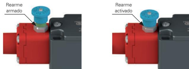
Si el indicador de tensión del cable se encuentra dentro de la zona de tensión correcta, se pueden cerrar los contactos eléctricos tirando del botón azul. El anillo verde de señalización permite saber rápidamente el estado del rearme.
