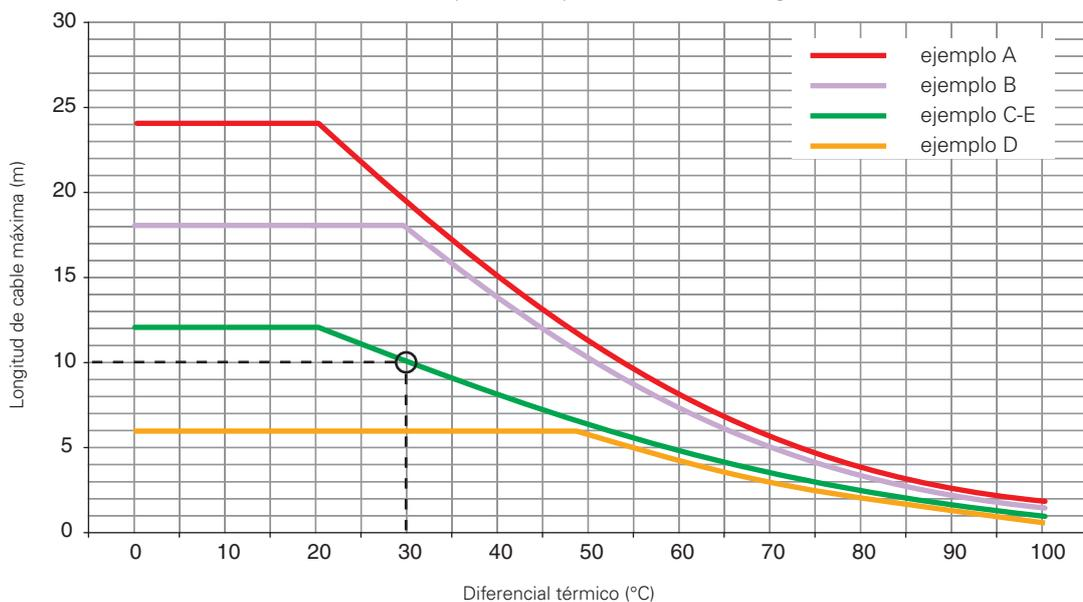
En el diagrama, se indican los vanos máximos recomendados en función de las variaciones de temperatura (diferencial térmico) a las que está expuesto el interruptor en el entorno de trabajo. Por ejemplo, en una instalación de tipo C y un diferencial térmico de 30°, se recomienda una longitud de cable máxima de 10 m.
