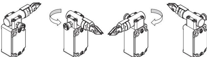
Tras retirar los cuatro tornillos de fijación, es posible girar el cabezal de todos los interruptores en pasos de 90°.
