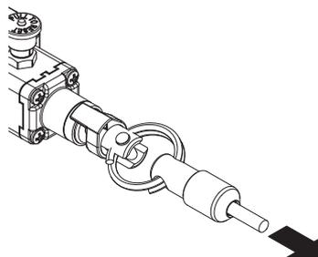
Estos interruptores se pueden suministrar bajo pedido con resortes internos de dureza reducida. Así, el esfuerzo necesario para accionar el interruptor se reduce sin tener que modificar el recorrido de accionamiento de los contactos eléctricos. Particularmente ventajoso para vanos de dimensiones reducidas, deben combinarse siempre con poleas.
