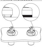
El anillo moldeado se puede utilizar cuando no se utilizan soportes para placas u otros dispositivos. Este impide que se acumule suciedad u otros residuos entre el potenciómetro y el panel de control o la caja.
