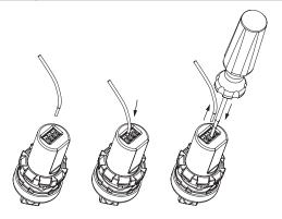
El potenciómetro dispone de una regleta de bornes de tres polos con un sistema de conexión por resorte tipo PUSH-IN. Esta tecnología permite un cableado muy rápido y sencillo, porque únicamente se tiene que insertar el hilo en el agujero correspondiente sin tener que utilizar ninguna herramienta y utilizando hilos rígidos o flexibles con puntera hueca fijada. Los cables se sueltan presionando el pulsador.
