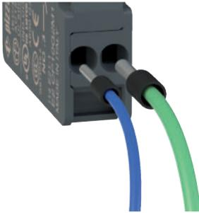
La conexión por resorte PUSH-IN permite un cableado sencillo y rápido, porque únicamente se tiene que insertar el hilo en el agujero correspondiente para establecer la conexión eléctrica (patente solicitada).
