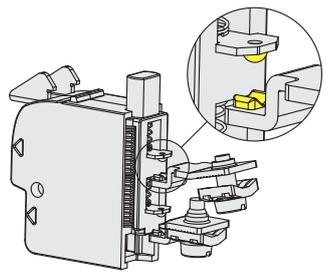
Contactos autolimpiantes con forma de «V» con punto de contacto cuádruple. Esta forma de contacto reduce drásticamente la probabilidad de error de conmutación del contacto, gracias a los cuatro puntos de contacto. Además, mejora notablemente la fiabilidad en entornos con polvo.
