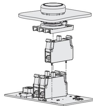
Los bloques de contactos de la serie EROUND para el montaje en el panel de control están disponibles como versión con pines de soldadura. Si se utiliza una placa de circuito impreso en vez de un cableado, estos bloques de contactos ofrecen la posibilidad de soldarse directamente.
