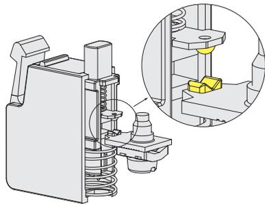
Contactos autolimpiantes con forma de «V» con punto de contacto cuádruple. Esta forma de contacto reduce drásticamente la probabilidad de error de conmutación del contacto, gracias a los cuatro puntos de contacto. Además, mejora notablemente la fiabilidad en entornos con polvo.
