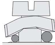
Las placas sujetacables con las que están equipados los bloques de contactos tienen un diseño especial (en forma de teja) y están conectadas holgadamente a los tornillos sujetacables. De este modo, al fijar los cables, la placa sujetacables se puede adaptar a los diversos diámetros de cable y aprieta los cables contra el tornillo y hace que no puedan deslizarse hacia el exterior.
