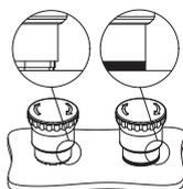
El anillo moldeado se puede utilizar cuando no se utilizan soportes para placas u otros dispositivos. Este impide que se acumule suciedad u otros residuos entre el pulsador y el panel de control o la caja. Es particularmente útil en sectores donde se requiere un alto grado de limpieza e higiene.
