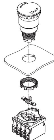
El actuador para la base con 4 huecos se debe montar tras haber fijado el pulsador.
