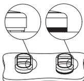
El anillo moldeado se puede utilizar cuando no se utilizan soportes para placas u otros dispositivos. Este impide que se acumule suciedad u otros residuos entre el pulsador y el panel de control o la caja. Es particularmente útil en sectores donde se requiere un alto grado de limpieza e higiene.
