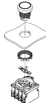
El actuador para la base con 4 huecos se debe montar tras haber fijado el pulsador.
