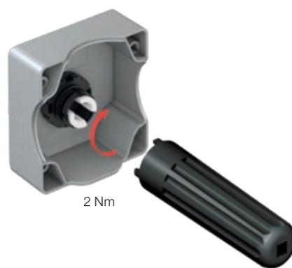
Dar apriete y torque con herramienta de fijación.
